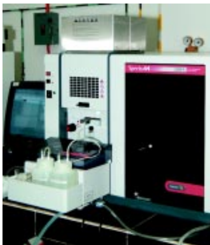
Espectrofotómetro de absorción atómica. Se utiliza para saber si un producto (de cualquier tipo: útiles, alimentos, calzado...) contiene metales pesados como plomo y cadmio.
