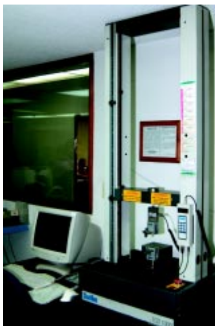
Tensómetro. Permite conocer la resistencia a la tensión de algunos textiles.
