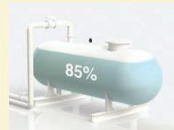
**9 Si vas a abastecer el tanque estacionario, ve que no pase del 85% de su capacidad,** ya que sobrellenarlo ocasiona que las válvulas de seguridad tiendan a abrirse para liberar presión y así una cantidad de gas escapa.
